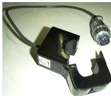
クランプ式電流センサ 型式:EACS1-600 (最大 600A)
