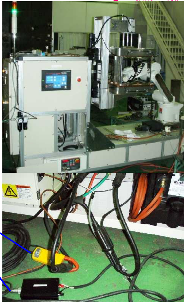
溶接電流検出センサ & 溶接電圧検出用高周波フィルタ
