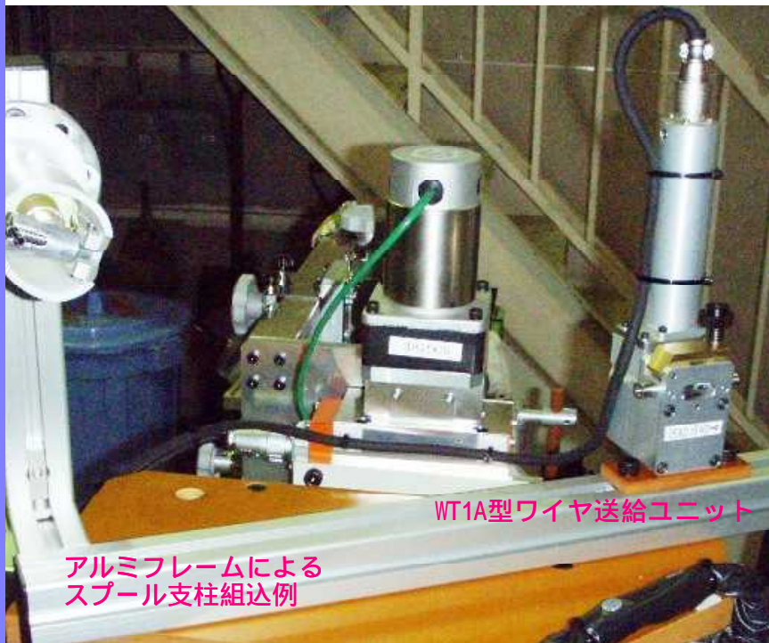
HSLシリーズ組込金具による WT1A組込例
