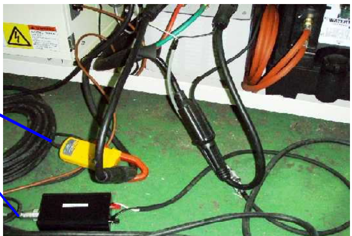
溶接電流検出センサ &溶接電圧検出用高周波フィルタ (TIG/プラズマ溶接用)
