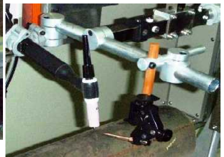
トーチ部組込例 ワイヤノズル調整機構WS-THR型
