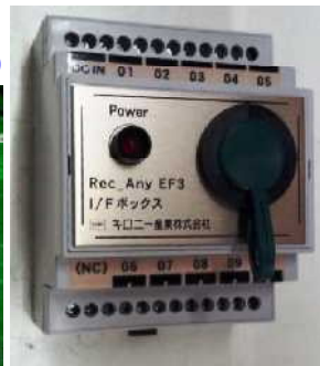
<< I/Fボックス >> 縦90×横70×高60mm電源電圧5～15VDC スイッチ・センサ10点まで接続・管理可能
