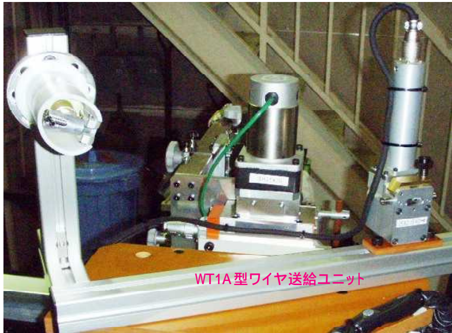
アルミフレームによる スプール支柱組込例
