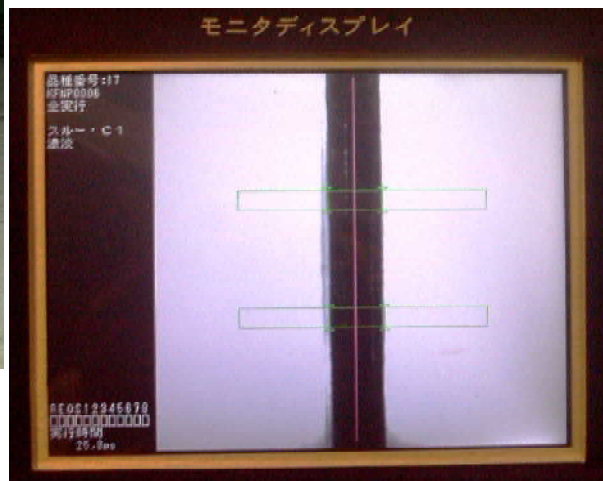
モニタディスプレイ(CC2002NP-200)表示例 赤線=センターライン 緑色枠=位置判断有効エリア(エラー時赤枠表示)
